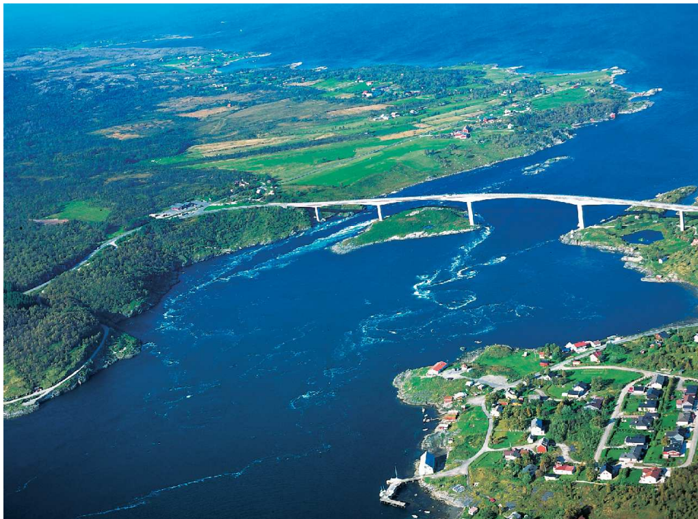
Figur 13.2: Flyfoto av Saltstrumen når den er for inngående. Strømstriper viser skjærlag og virvelstrukturer i samsvar med skissen i fig. 13.3. Foto: Eiliv Leren ©.
